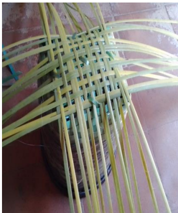
Foto 21 Fundo da rasa em construção fixado à forma. Fonte: Acervo do autor
